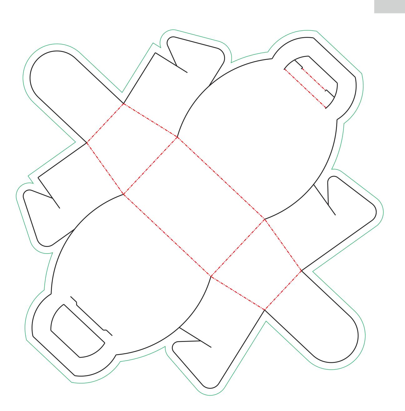
Bitte legen Sie Ihr Design innerhalb der von uns vorgegebenen Linien an. Die türkise Linie ist die Stanzlinie, an der das Produkt am Ende beschnitten wird. Die gestrichelte Linie ist die Falzlinie.
